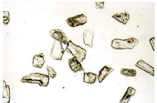
図V-23 長石偏光顕微鏡写真(単ニコル)
