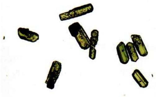
図V-7 単斜輝石偏光顕微鏡写真(単ニコル)
