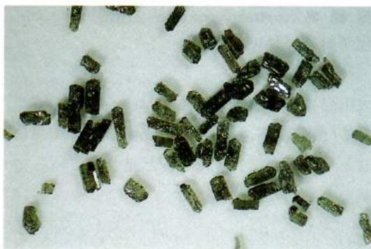
図V-5 単斜輝石実体顕微鏡写真
