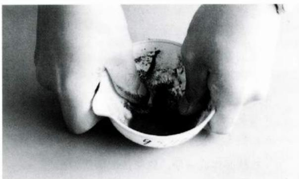
図Ⅳ-1 蒸発皿に水と試料を入れ塊をつぶす
