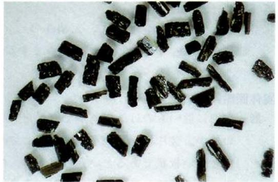
図V-11 角閃石実体顕微鏡写真
