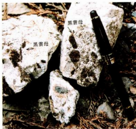
図Ⅱ-9-5 Spot 2 のズリで見られるベグマタイトとその中の黒雲母
