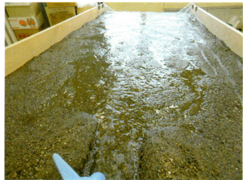
写真④ 水を流しながら砂を供給すると生じる川幅の広い流れ
