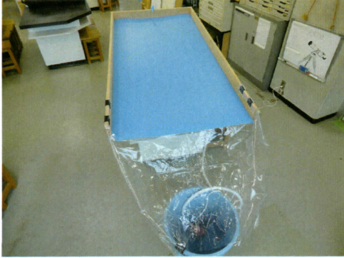
写真① 実験台に設置した水路
