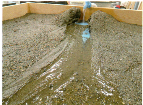
写真⑥ 下刻が進んで形成された河岸段丘
